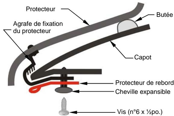
8. De gauche à droite, installer chacune des quatre agrafes du protecteur sur le rebord du capot. S'assurer que les agrafes sont sous le joint d'étanchéité et non par-dessus. S'assurer que les agrafes sont engagées jusqu'au fond contre le rebord du capot.
