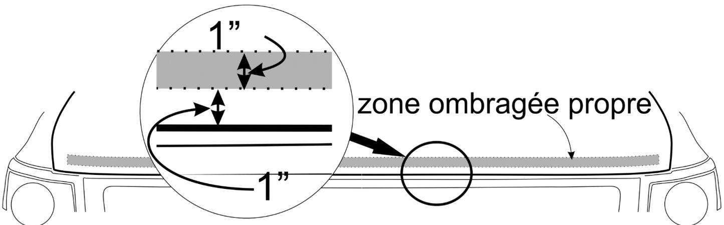
4. Centrez le joint "D" sur le côté du capot. 48 "est prévu. Il peut être nécessaire de couper légèrement la longueur pour épouser les contours du capot.
