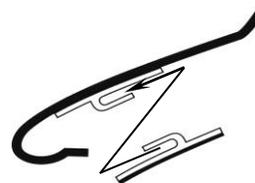
4. Peler la bande protectrice du ruban sur le piédestal. Pendant on garder les piédestaux au-dessus la surface du capot, glisser la languette inférieure sous le capot, s'assurer que le déflecteur est bien centré, puis pivotez et poussez le déflecteur en place. Poussez sur les piédestaux agrafes pour s'assurez qu'elles sont bien adlérer sur le capot. *Voir les illustrations ci-dessous.*
