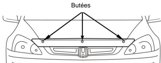
7. Sur certains véhicules, il peut-être nécessaire d'ajuster les butées du capot et (ou) la fermeture du capot pour obtenir un bon dégagement.
