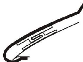
5. Élever le capot du véhicule sans déranger l'emplacement du déflecteur. Centrer le déflecteur sur le capot. Introduire les bouchons expansibles dans les trous du déflecteur et du capot. S'assurer que le déflecteur repose bien contre le capot, puis introduire les vis dans les bouchons expansibles et les serrer.
