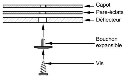
6. Installer le deux (3) butées tel qu'indiqué ci-dessous. **Attention: Les butées doivent être installées sur le capot et non sur le déflecteur!!!! Si les butées sont installées sur le déflecteur, elles useront la peinture.**
