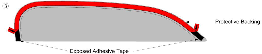
4. Repositionnez les déflecteurs sur les cadres de porte à 19 mm (3/4 po) du bord de la porte. Si nécessaire, ajustez le déflecteur pour un meilleur ajustement.
