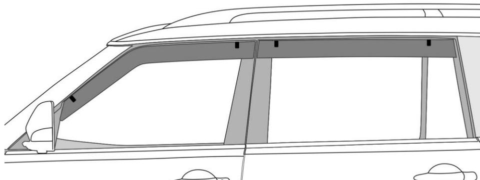
5. Nettoyez les zones de montage agressive avec un tampon d'alcool d'essuyage et séchez avec un chiffon ou une serviette en papier propre pour enlever toutes les traces de doigts, huiles ou cires qui peuvent être sur la surface.
