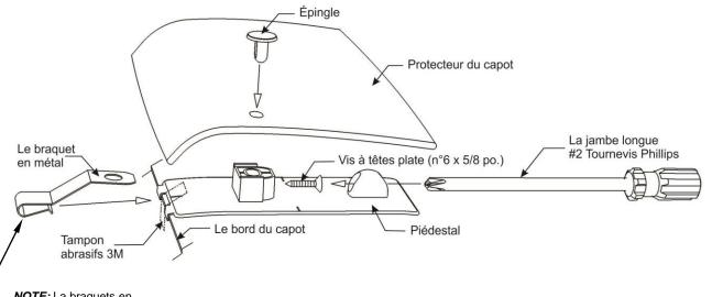
**NOTE:** La braquets en métalliques sont installés au centre et emplacement à l'extérieur uniquement.
