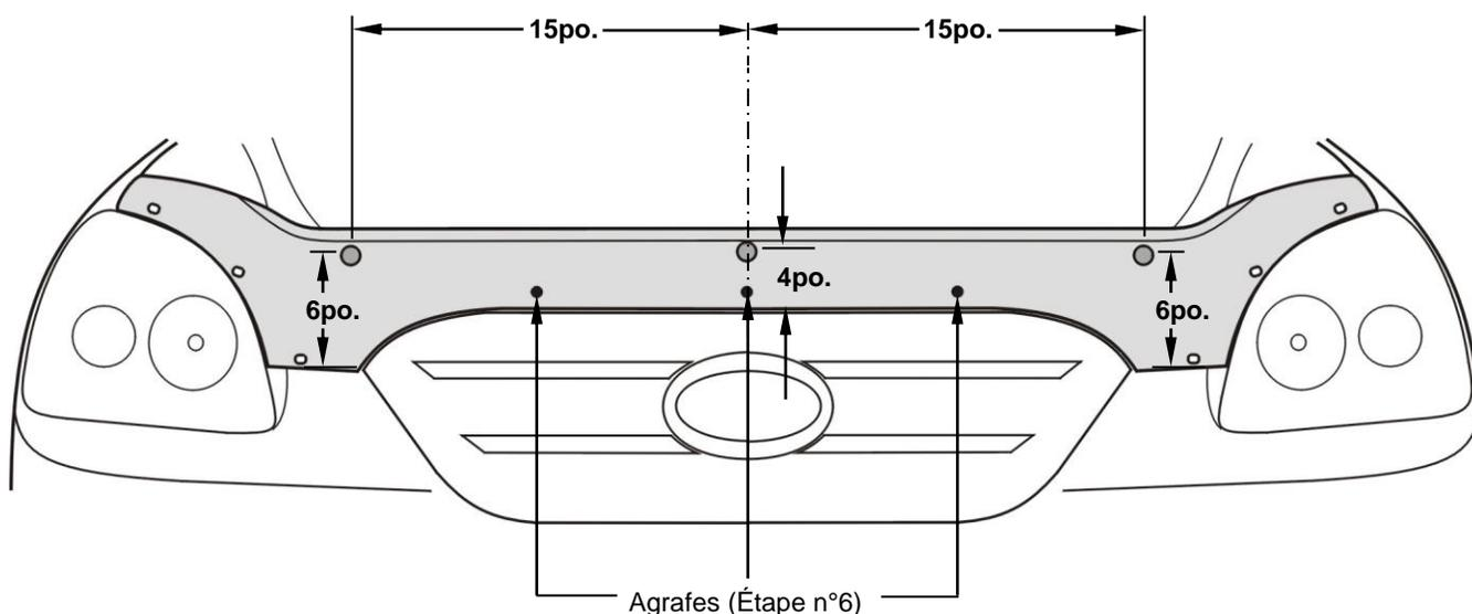
7. Peler et plier en deux les tampons anti-abrasifs sur la bordure avant du capot en dessous des (2) deux trous intérieurs. Voir l'illustration n°2 – étape n°7.
