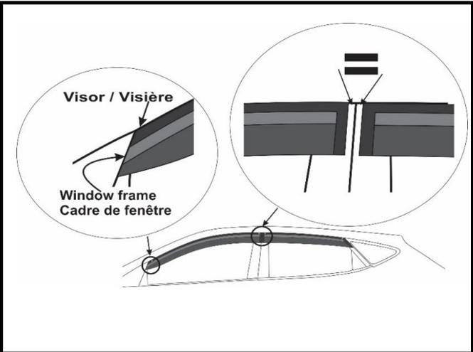
**2 Test fit visors / Test d'ajustement des visières**
