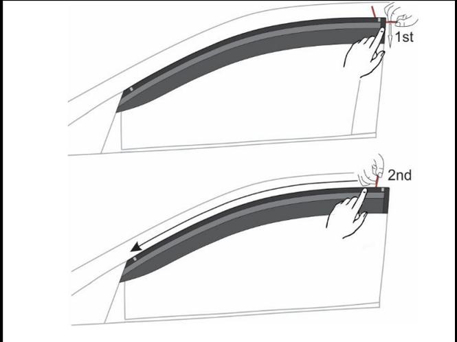
**4 Set visor in place and peel tape / Réglez la visière en place et peler la bande**
