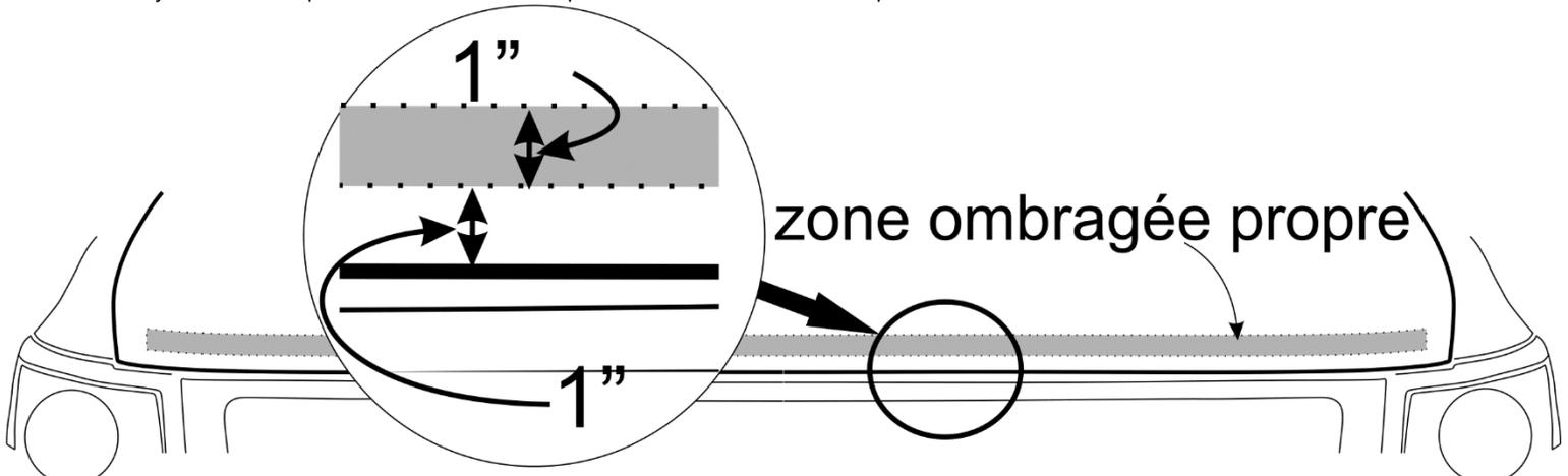
4. Centrez le joint "D" sur le côté du capot. 48 "est prévu. Il peut être nécessaire de couper légèrement la longueur pour épouser les contours du capot.
